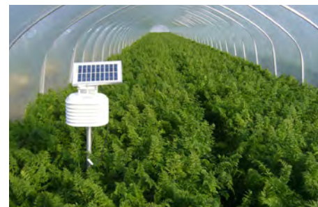
商用電源がなくても作動し施設内の気温 を正確に測定できる低コストな遠隔測定 システム
