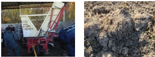
ビートハーベスタ(左)で収穫すると、 収穫物への土砂の付着が激しい(右)
