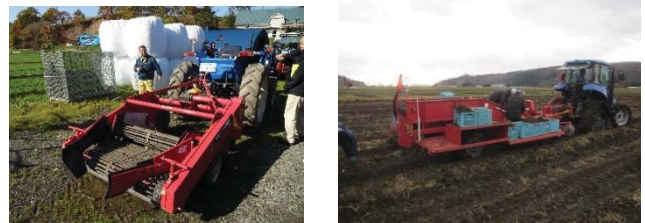
ポテトディガー(左上)で掘り上げ、攪拌後、アーリーディガー(右上)で収穫する。収穫物への土砂の付着がほとんどなく、乾燥調製時間を25%短縮するとともに乾燥コストが削減される。
