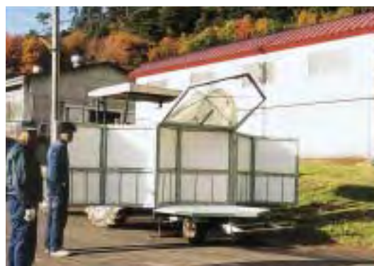
図2.29 天井と側壁が開き、ロールベールが入れやすい。
