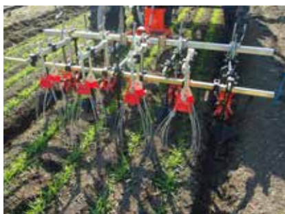
トラクタや乗用管理機に装着します。4条~8条用があり(写真は4条用)、条間は30cm以上必要です。
