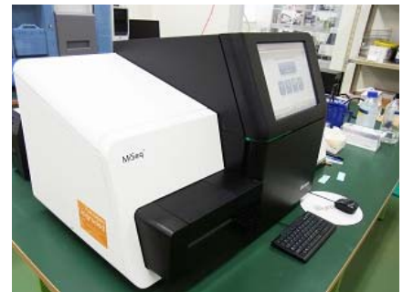
ゲノムワイドに塩基配列を解読する次世代シーケンサー (NGS : MiSeq 仕様)
