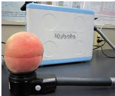
**図1** 接触型非破壊糖・酸度計（フルーツセレクター K-BA100R, クボタ）によるモモ果実測定の様子。
