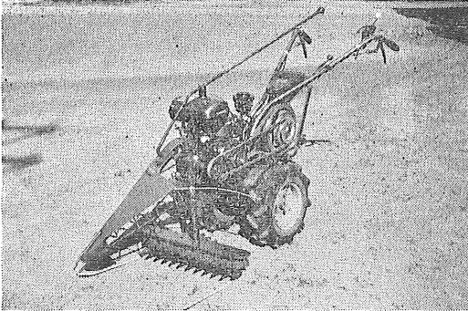
第 I-44 図 サトー式 HA17 型刈取機によるドリル 播小麦 3 条刈りの刈跡 (Fig. I-44. Stubble field of drilled wheat harvested by 'Satoh HA17')
