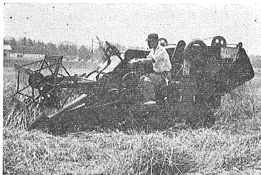
第Ⅱ-28図 HTN623型コンバインの作業 (Fig. II-28. HTN623 working in a field)
