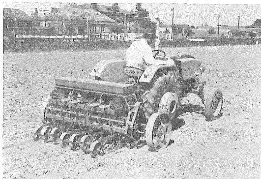
第IV-1図 装架式7条施肥播種機
