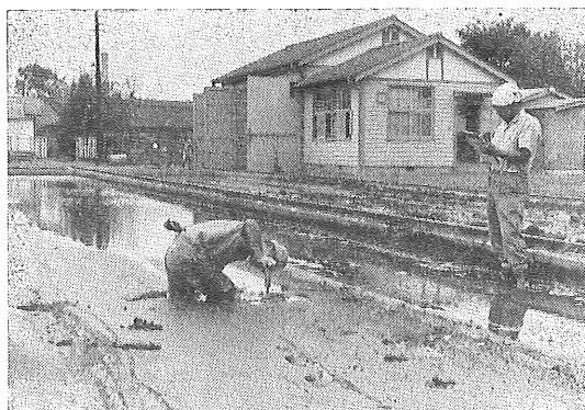
第 I-25 図 柔軟土壤の矩形板沈下量測定
