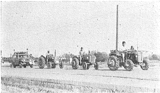
第Ⅱ-11図 ダイナモメータ・カーの性能試験
