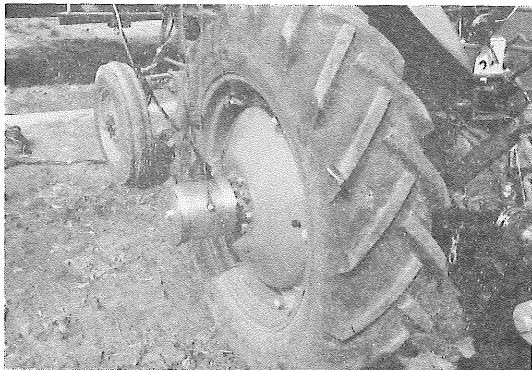
第Ⅲ-3図 防水被覆をした車軸トルク・ピックアップ
