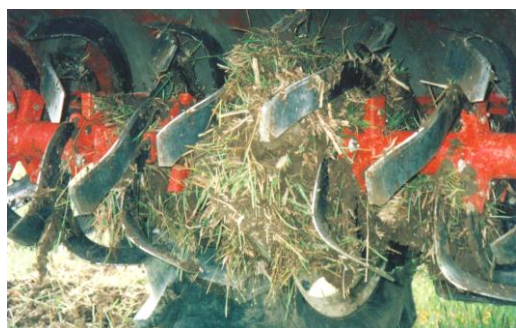
写真 3-3 3回切削式試作機の土抱込み状態
