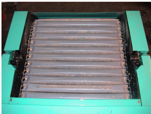
図 4-3 扁平タイトバーによる成形室構造（成形室上面）
