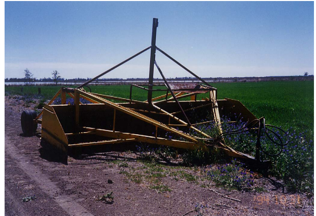
写真 1-9 トラクタけん引式均平機
