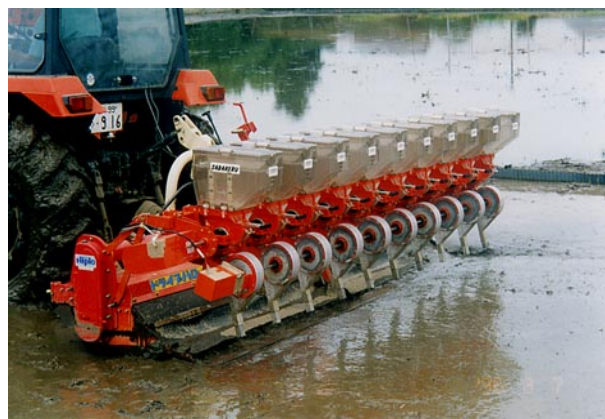
写真 1-21 代かき同時土中点播機
