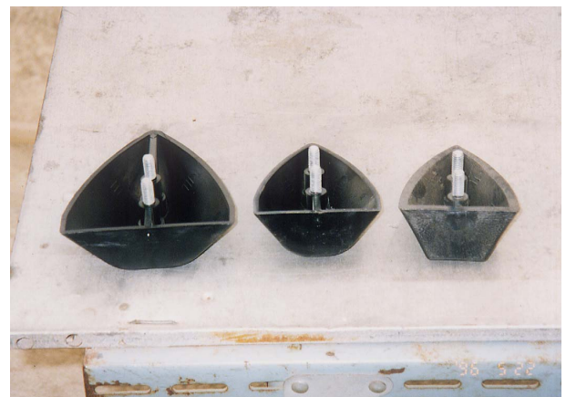
写真 1-15 乗用湛水点播機の作溝器
