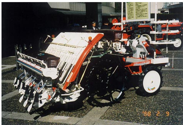
写真 1-20 田植機アタッチメント式条播機
