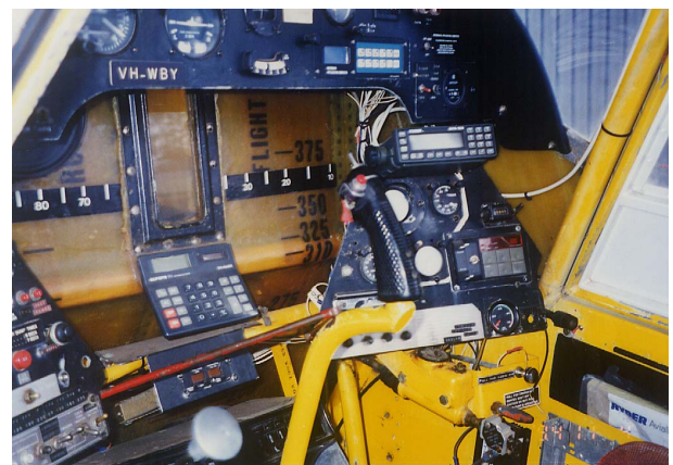
写真 1-5 コクピット前方の籾タンク
