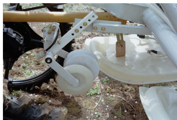
写真 2-2 条播機に搭載したリアルタイム土壌表面硬度センサ
