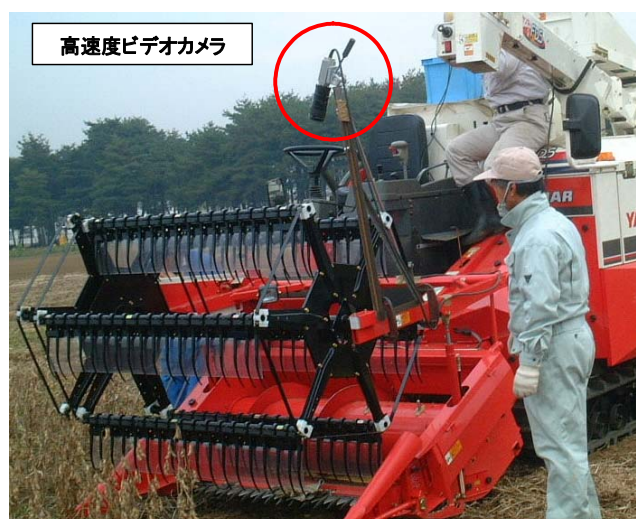
図2-1 高速度ビデオカメラによる刈取りの撮影方法
