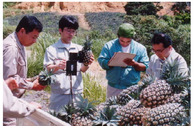
図 4-18 太陽光下での透過光量測定
