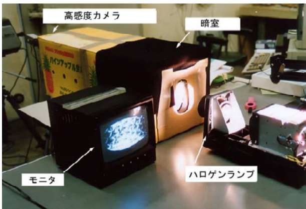
図 4-6 高感度カメラによる透過光の映像化
