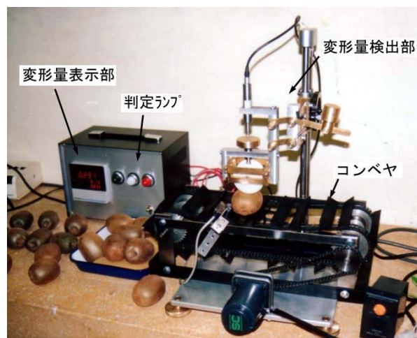
図 2-19 変形量検出部の基礎試験装置
