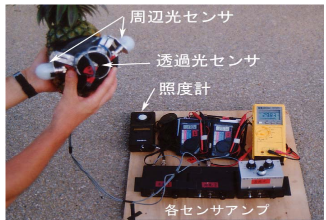
図 4-21 周辺光量と透過光量測定の基礎試験装置
