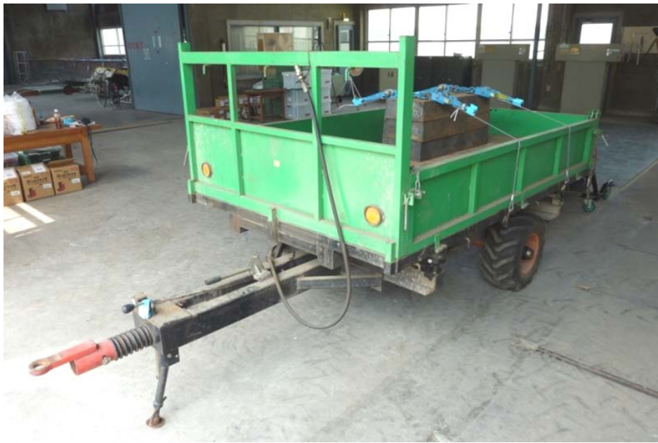
図2 高速走行時安定性試験に用いた対照機
