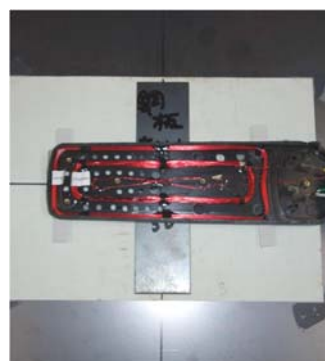
c) 設置状況 (鋼板、幅 50 mm)
