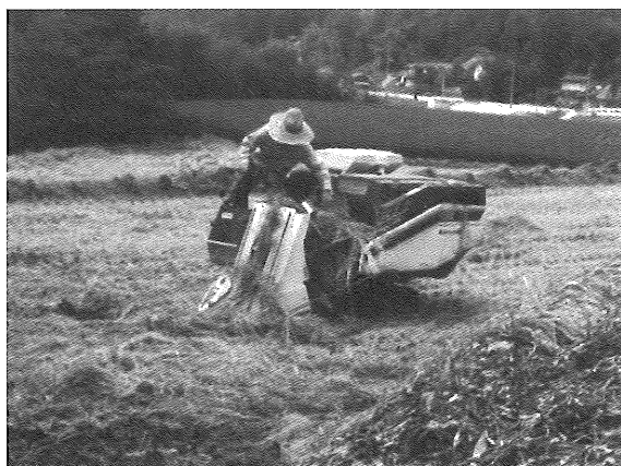
図1 確認された危険作業事例：詰まりを除去しながら刈取
