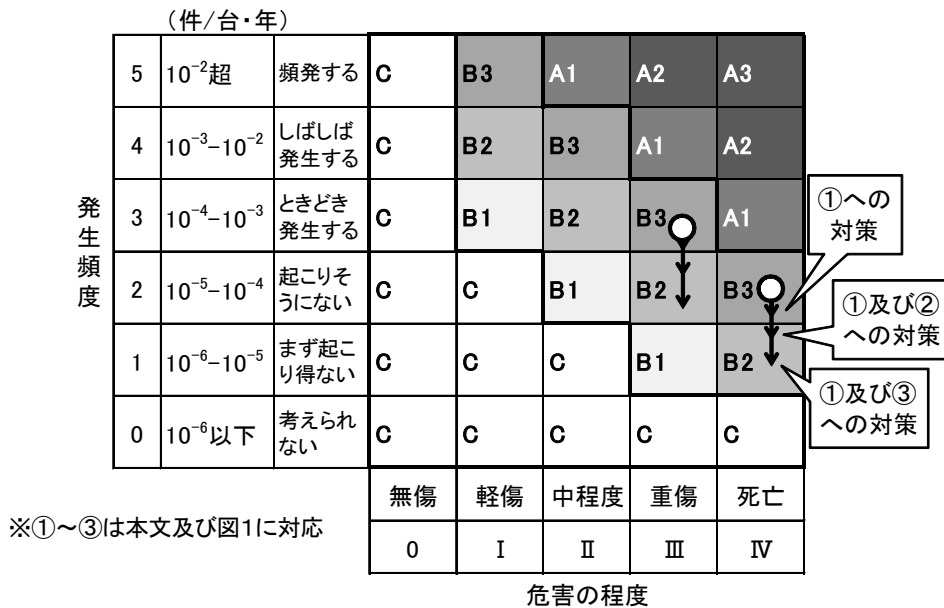
図 3 乗用トラクタの転倒転落事故のマクロ分析結果に基づく R-Map 評価結果
