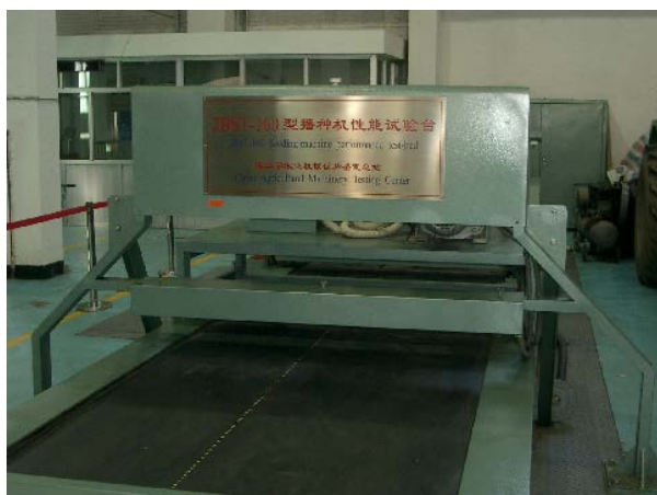
图10 播種精度試験装置
