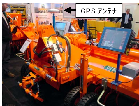
図 14 作業機自動制御ユニット (SBG INNOUVATIE)
