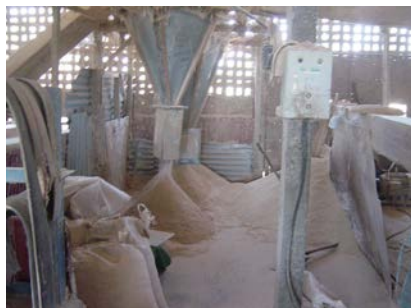
図4 精米機裏の糠等排出場
