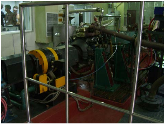
図 25 機関排出ガス性能試験ベンチ
