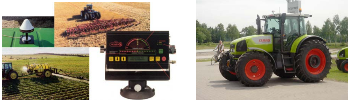
図4 曲線に追従する自動操舵が可能なシステム（左）と搭載トラクタ（右）
