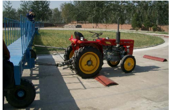
図 13 走行系耐久性試験装置
