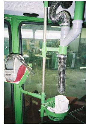
図20 小サンプル キャビンまでサンプルが送られ、左のダイヤモンドプリンタと連動。
