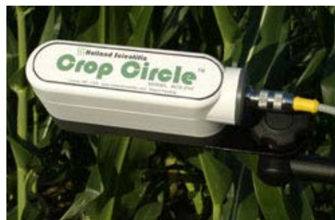
図 15 生長量計測センサ (Soil essentials)
