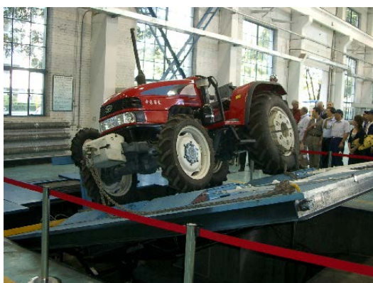
図6 転倒角試験装置
