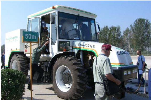
図 12 けん引性能試験装置（ダイナモメーターカー）
