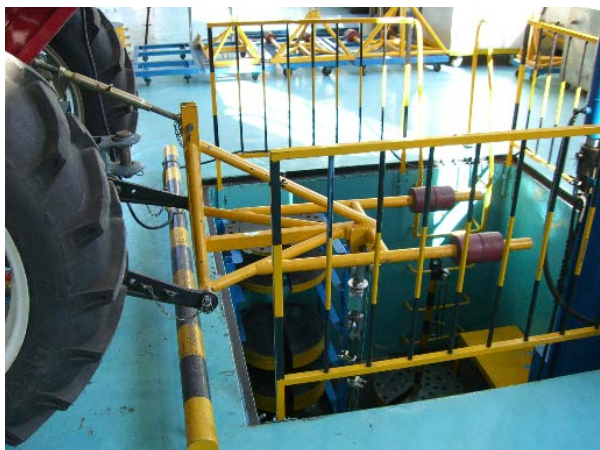
图7 油压揚力試験装置
