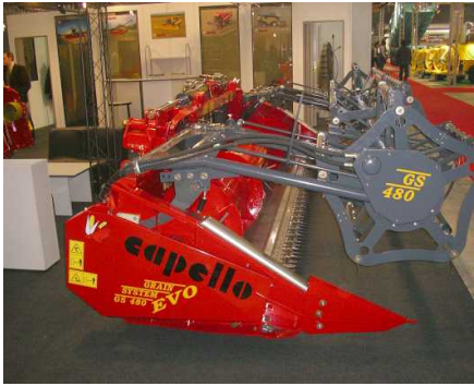
図7 デザインに優れたcapello社のリールヘッダ リールに油圧モータを使用。
