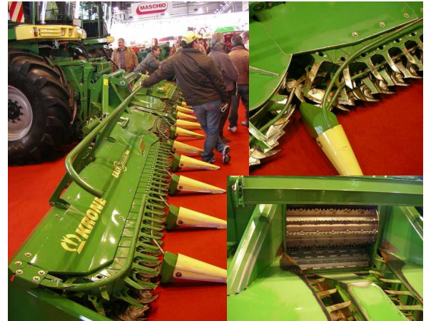
図2 KRONE社自走式コーンハーベスタ 爪は3段構造で1、2段目が切断、2、3段目と条間毎にあるガイドバーが搬送を担う。12条刈りで折り畳み可能。
