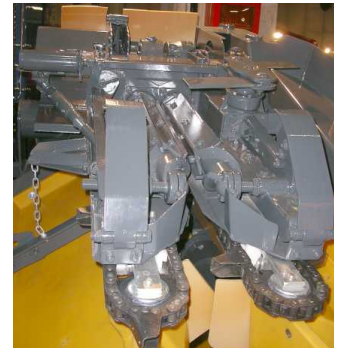
図8 ロークロップ刈り取り部の裏側 作物を引上げ切断。
