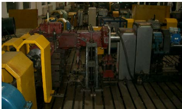
図 21 トランスミッション耐久性試験装置
