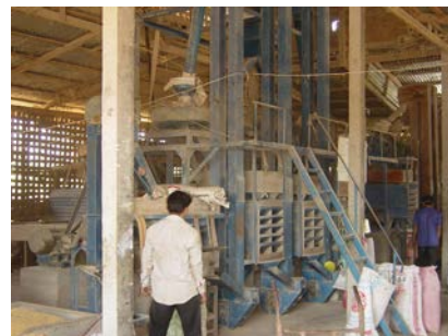
図5 粳摺り～精米の機械化工程
