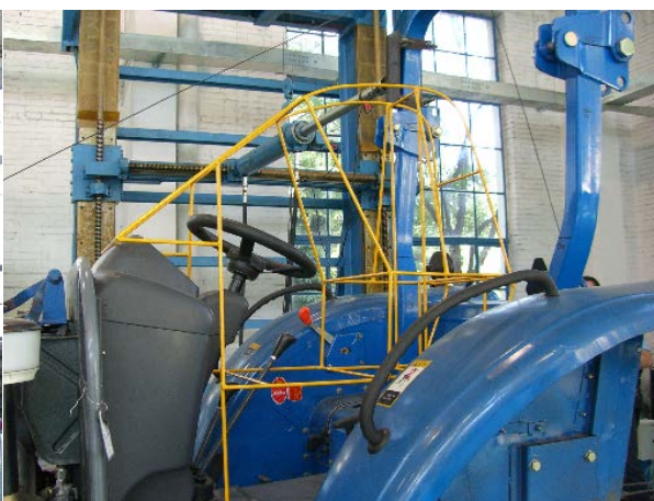
图9 安全キャブ／フレーム静的強度試験装置
