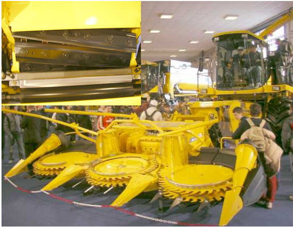
図1 NEWHOLLAND社の自走式コーンハーベスタの分割展示 写真上はカタヘッド。出力は379kW。
