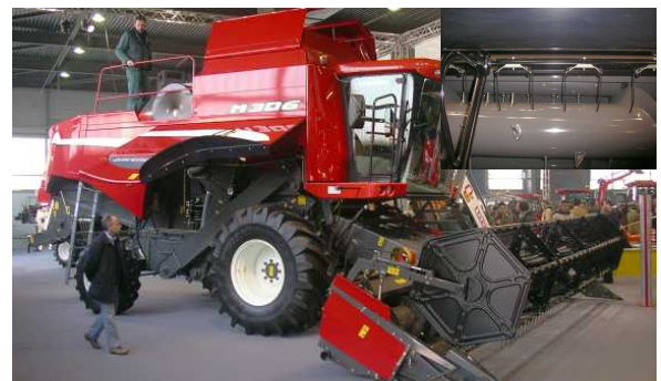
図6 Laverda製のコンバインM306 刈り幅4.8～6.6m、225kW。グレタンク9,000L。ユニークなフィーダー。
