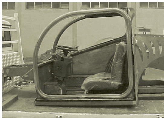
図2 変形 ROPS の例 (イタリア／ポローニャ資料より)
