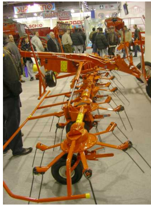
図7 6軸の折り畳み式ジャイロテッダ
