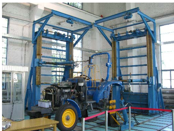
图9 安全キャブ／フレーム静的強度試験装置
