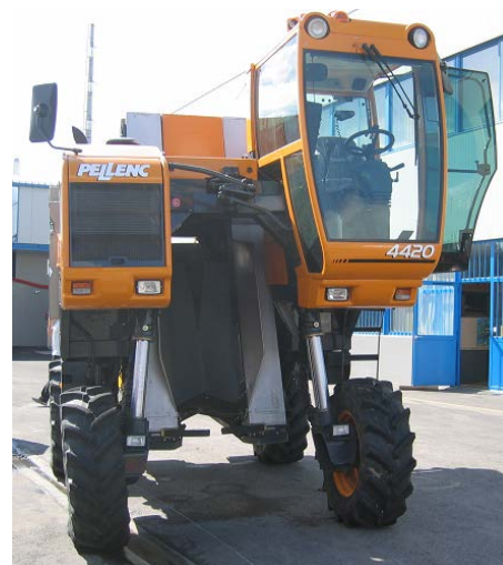
図 10 ワイン用ブドウ栽培用の多目的ビークル
