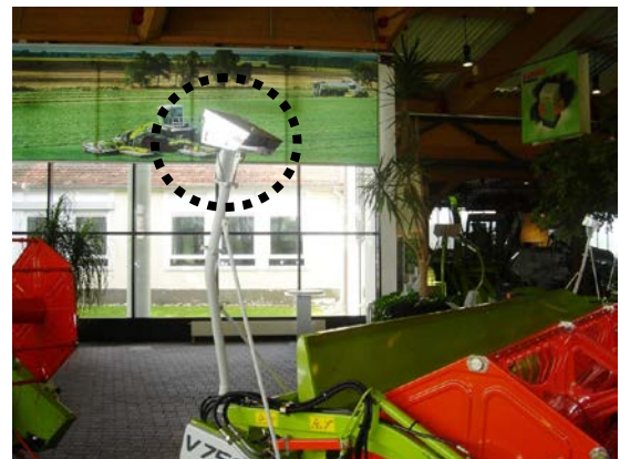
図5 コンバイン自動追従用センサ (図中点線内)
