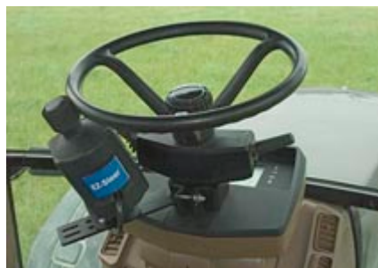
図3 簡易で安価な経路表示システムと自動操舵システム
