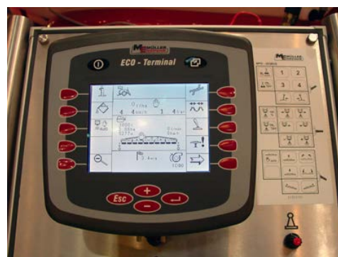
図 16 フームスプレーヤ用制御コントローラ (Müller Elektronik)
