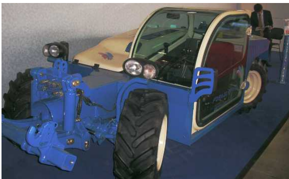
図9 ANDREOLI社の園芸用トラクタ ハウス内や葡萄棚の下で作業する。4輪操舵。全高 138cm、96kW、最大登坂能力60%。大メーカーでは製作され難い逸品。
