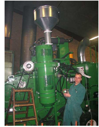
図17 コンバインのグ レン収量計量部
