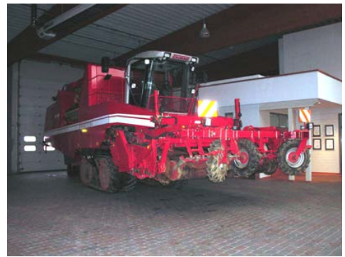
図7 バレイショ自走式収穫機
