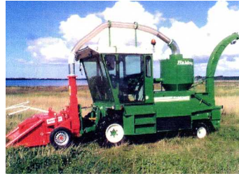
図16 コーンハーベスタ フォレージハーベスタ と同様のシステムであるが、シュートに NIR 分析システムを取り付け可能。カタログより。
