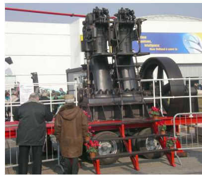
図10 1904年製ディーゼルエンジン 66馬力 220rpm
