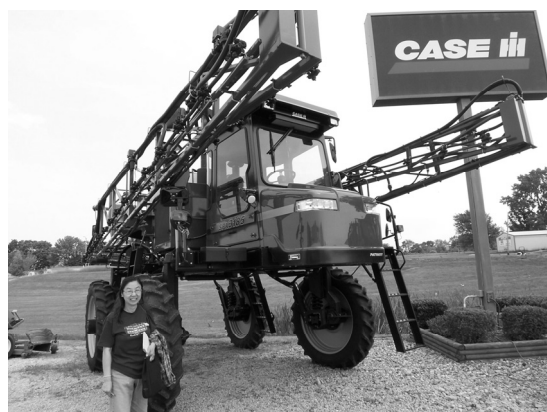
図 12 ブームスプレーヤ:ブームを広げると90フィート(約27m)、容量は750ガロン(約2,850L)
