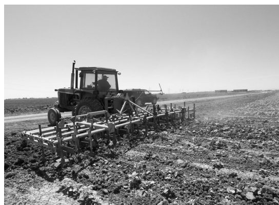
図21 中耕除草機：カメラにて作物列を検出し、条間処理を可能としている。
