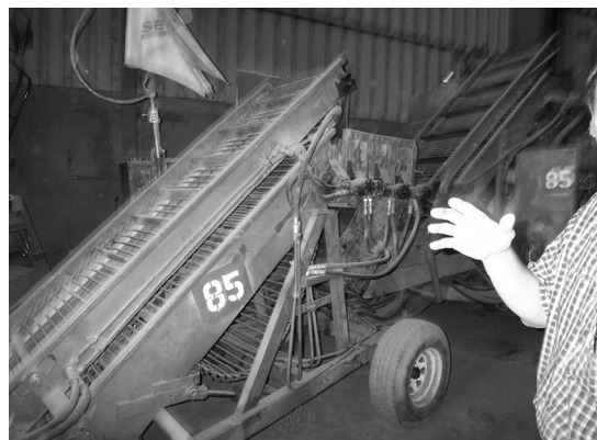
図19 メロン収穫機：種子採取を目的としており、後部に実と種を分ける回転タンクを装備。
