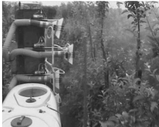
図10 精密防除機散布状態
