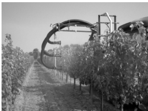
図2 ブドウ用多条エアアシスト防除機 (イタリア、Universita degli Studi Torino)
