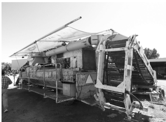
図18 トマト収穫機：色彩選別機、収量センサを搭載し、収穫同時選別を行う。
