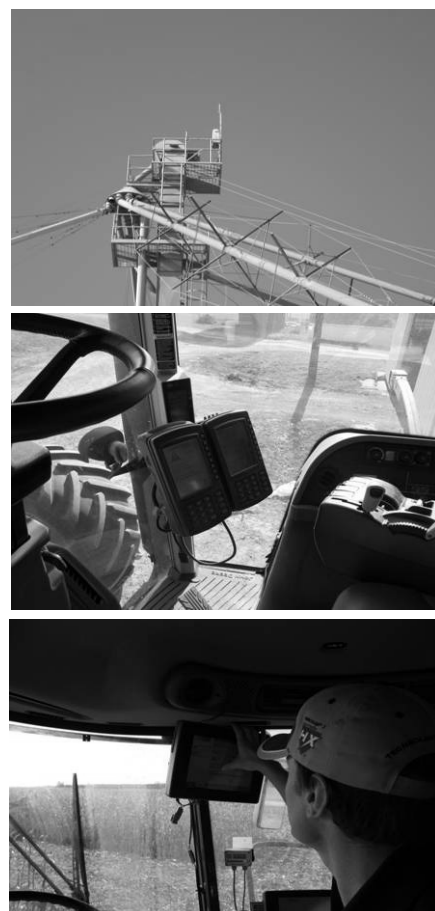
図10 Mitchell Clay Farmにて (上:乾燥施設に取付けられた無線LAN設備、中:トラクタに搭載されたAuto-Steering機器、下:収穫作業中にAuto-Steering機器を操作するMitchell Clay氏)
