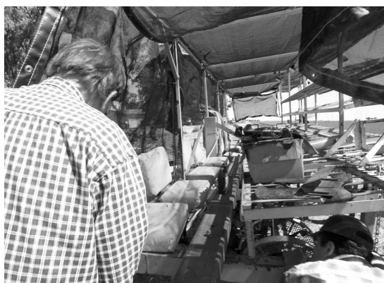
図20 トマト移植機：横一列に10人が着座する移植機。大型トラクタで牽引し、回転ロールに苗を人間がセットする。
