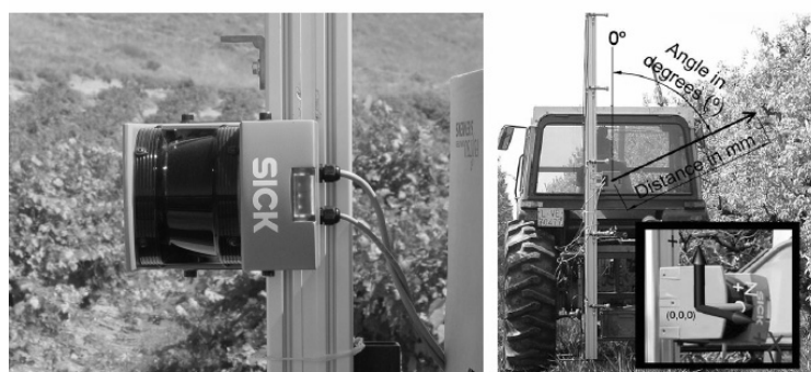
図4 樹体形状を測定するためのレーザセンサ (スペイン、University of Lleida)
