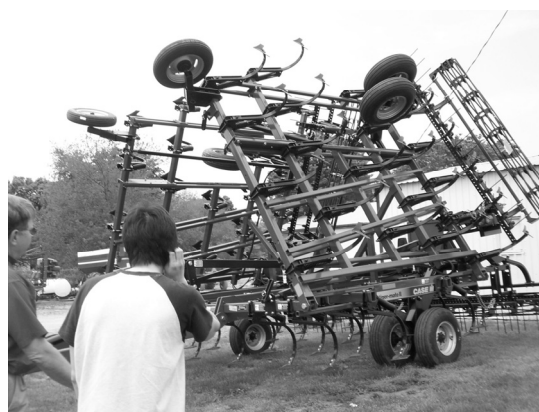
図 13 カルチベータ:コイルタインとハローがついたタイプ
