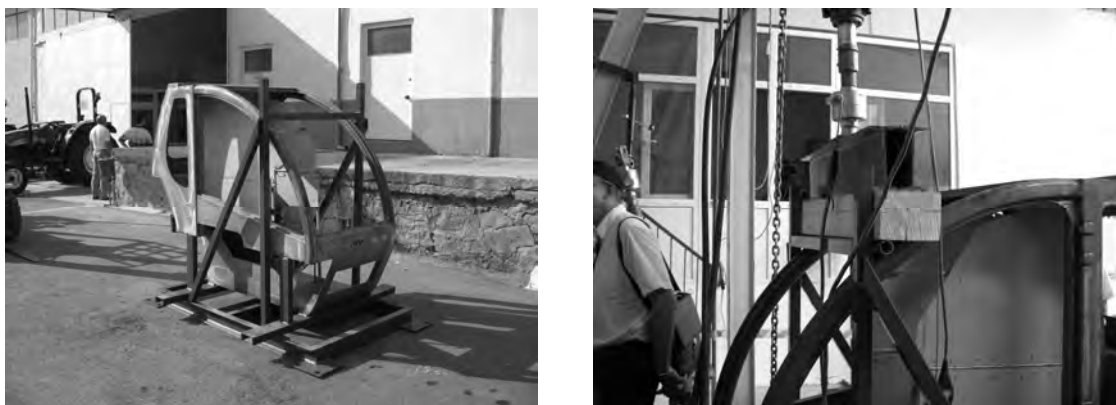
図4 Round Shaped ROPS(曲線形状の ROPS)の圧壊試験デモンストレーション風景
