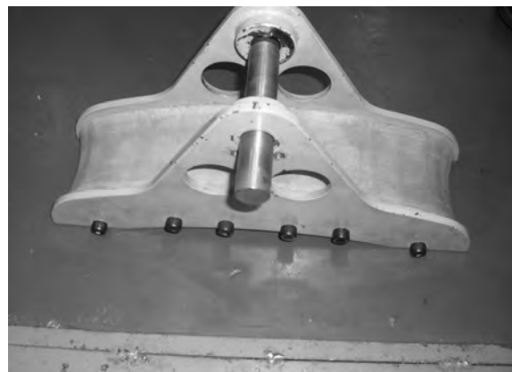
図 20 シートベルトのアンカレッジ試験用ジグ
