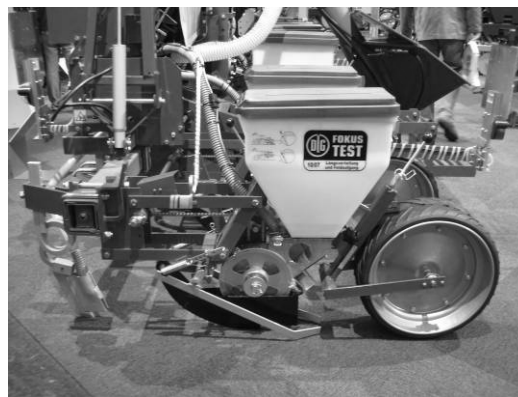
Becker 社の精密播種機、左が不耕起用、右がプラウ耕後用
