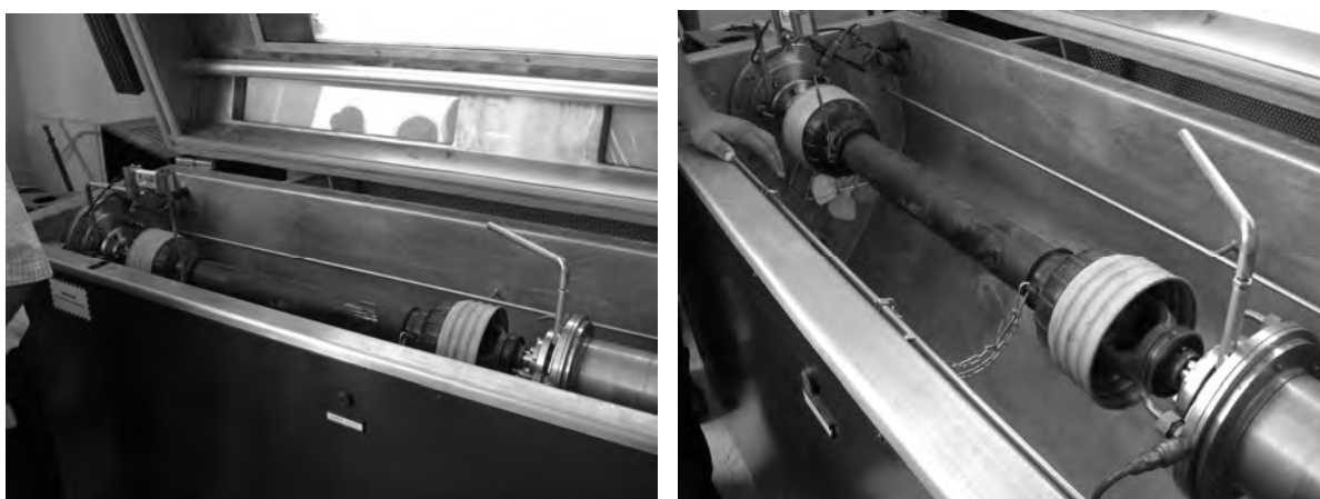
図 14 ドライブシャフトカバーの耐久試験装置
