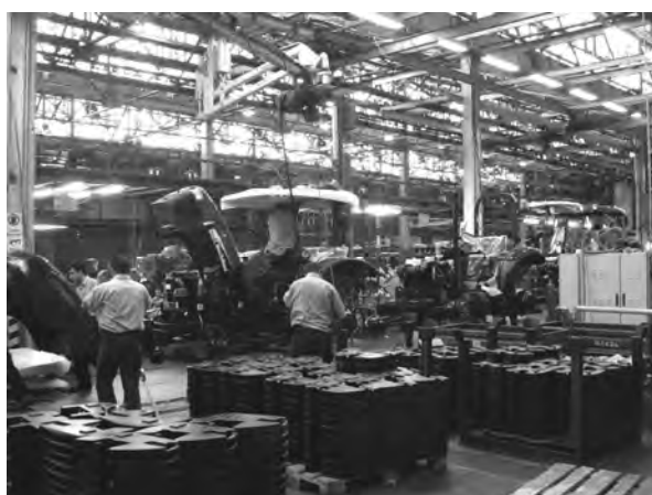
図 17 安全キャブやキャンピーの取付けライン
