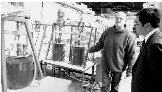
メタンガス生成過程の1次処理と見なされるサイレージを原料とした発酵の研究設備と説明者の Dr.Thorsten Ahrens 氏
