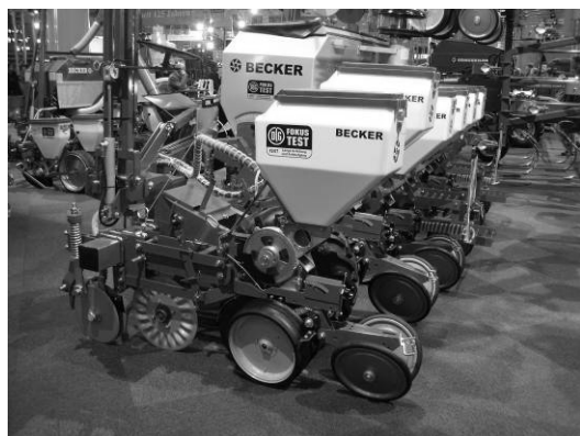
Becker 社の精密播種機、左が不耕起用、右がプラウ耕後用
