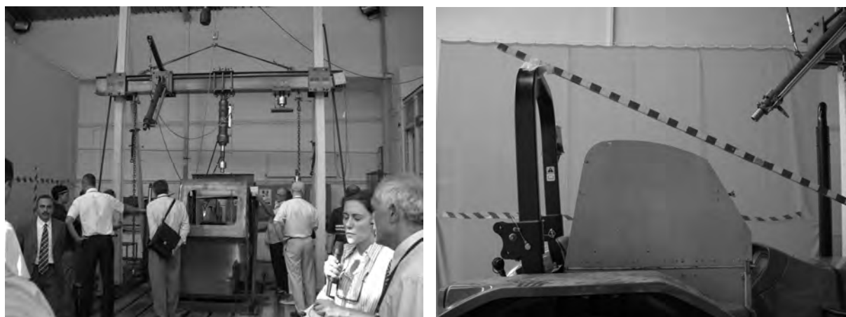
図9 安全キャブ/フレーム静的強度試験装置
