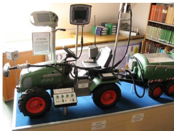
図 7 学生が製作した ISOBUS システムのモデル（ミュンヘン工科大学）
