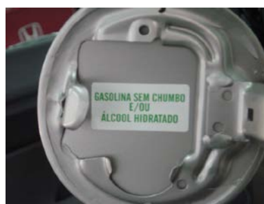
図 6 100%アルコールの給油口
