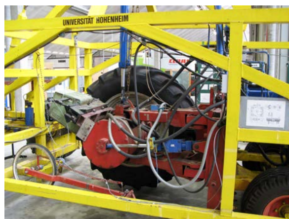
図 8 トラクタホイール応力測定装置（ホーエンハイム大学）
