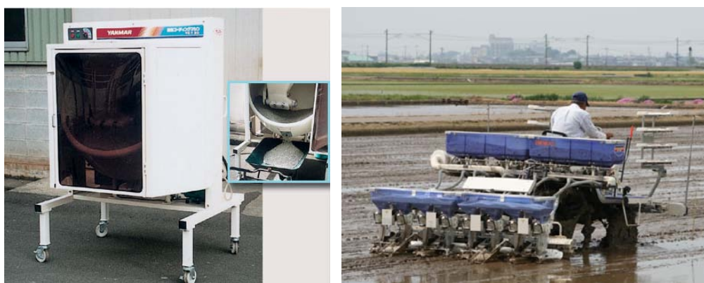
図 4 水稻種子自動コーティング装置(左)と高精度水稻湛水条播機(右)
