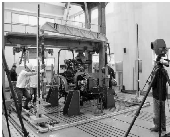
図 15 後部圧壊試験
