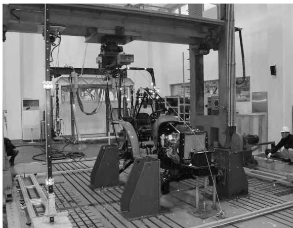
図 12 安全域の模型を直接搭載した強度試験
