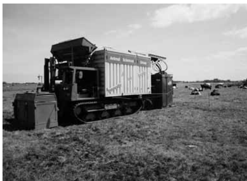
図1 移動型搾乳ロボット (Mobile Milking Robot)
