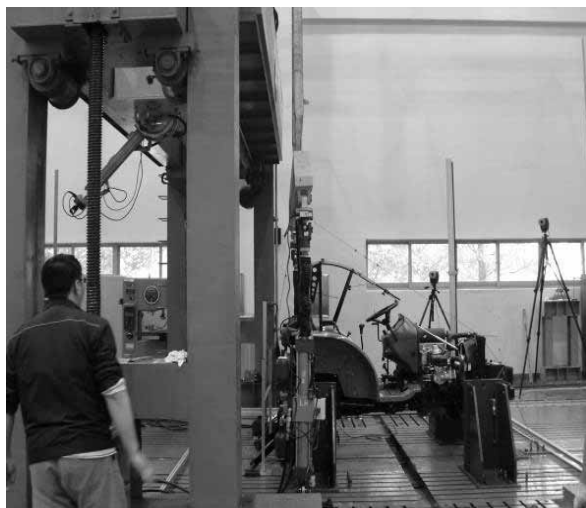
図 17 前部圧壊試験
