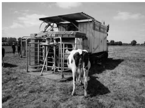
図1 移動型搾乳ロボット (Mobile Milking Robot)
