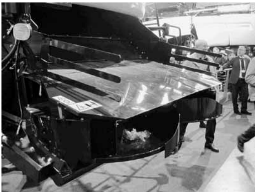
図 22 安鑑基準は認められない 可動部防護の例
