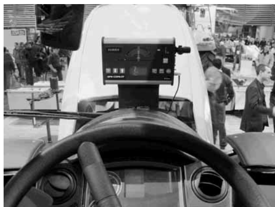
図 9 GPS による航法支援装置
