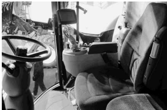
図 24 緊急停止ボタンが座席より後方にある例
