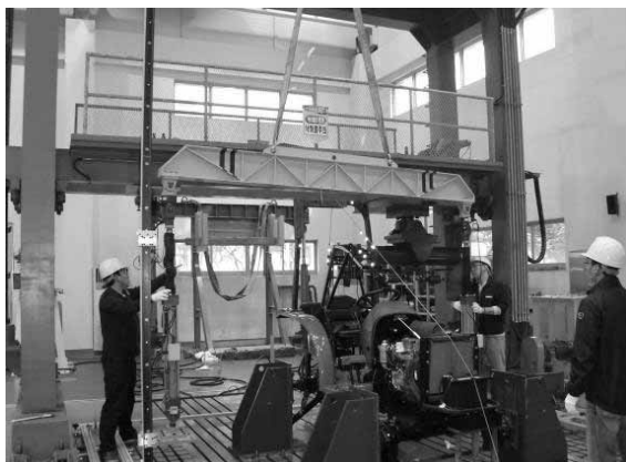
図9 垂直負荷試験装置
