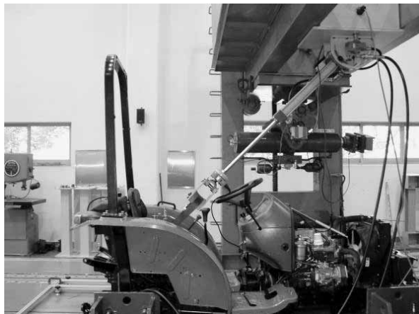
図 18 前方引張試験
