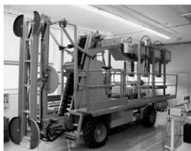
図6 シトラスの圃場選別装置（スペイン）
