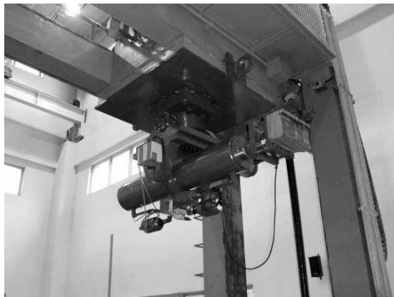
図8 水平負荷試験装置
