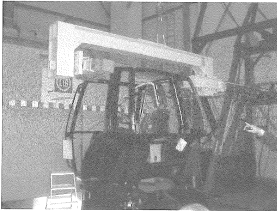
図 14 ROPS 試験装置（右は装置の操作盤）
