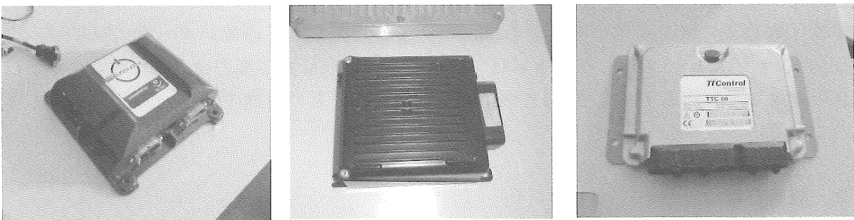
図 19 Re:Lab 社の ISO バスソフトウェアが組み込まれた ISO バス用 ECU
