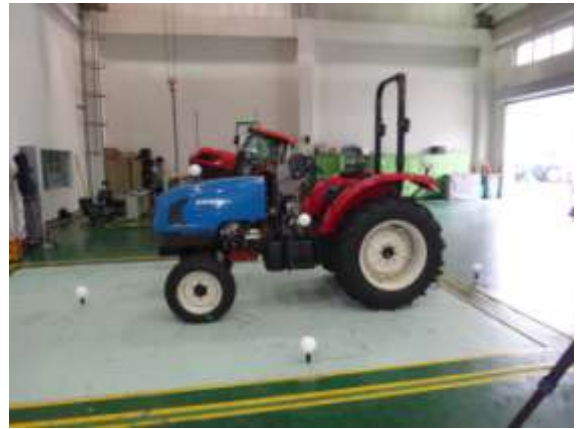
図 3-1-8 測定のために設置した基準点
