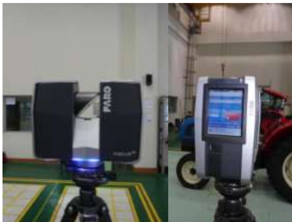
図 2-1-4 レーザースキャナ三次元測定器（FARO 製）と基準マーカ
