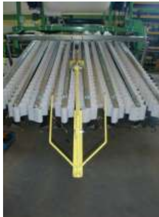
図 19 自動操縦機構の作物列検出部
