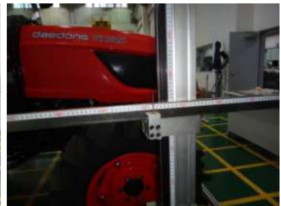
図 3-1-6 構造寸法測定治具のスケール部
