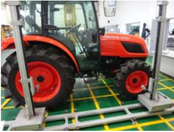
図 2-1-3 アルミフレーム製三次元寸法測定装置
