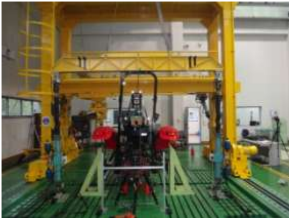
図 3-1-3 垂直負荷試験装置（2 種類） シリンダストローク：725mm 許容負荷：10t, 30t 制御速度：2mm/s 以下
