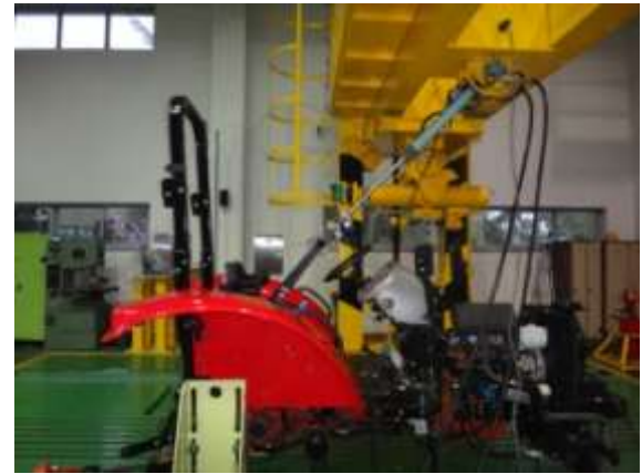
図 3-1-4 シートベルト引張試験装置 シリンダストローク：500mm 許容負荷：1t 制御速度：0.1～5mm/s
