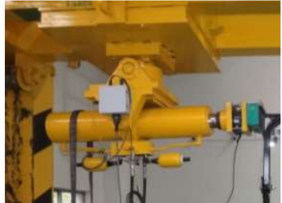
図 3-1-2 水平負荷試験装置 シリンダストローク：1000mm 許容負荷：10t 制御速度：0.1～5mm/s 負荷可能範囲：高さ 1～4m、左右 4m、 前後 7m
