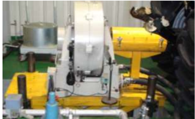
図 2-2-1 渦流式電気動力計（昇降台上）
