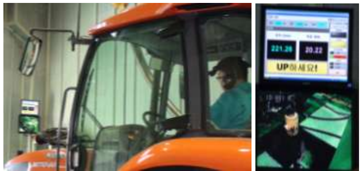
図 2-4-4 揚力測定試験の様子 （左：前方モニタの位置、右：表示内容）
