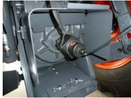
図 2-3-1 PT0 回転速度検出装置
