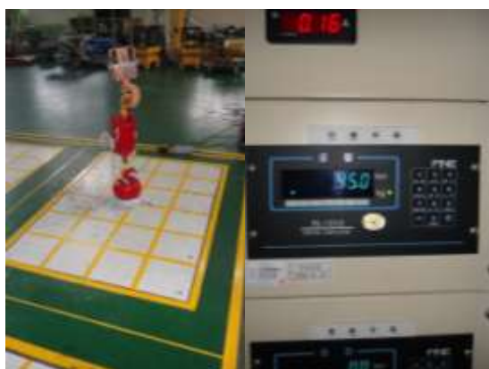
図 3-3-2 FOPS 試験用重錘（45kg）
