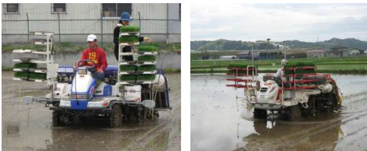
図1 基肥用可変施肥装置（左：I機、右：Y機）
