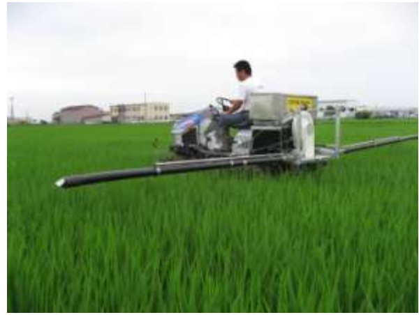
図2 追肥用可変施肥装置（左：粒状物散布装置、右：散粒機）
