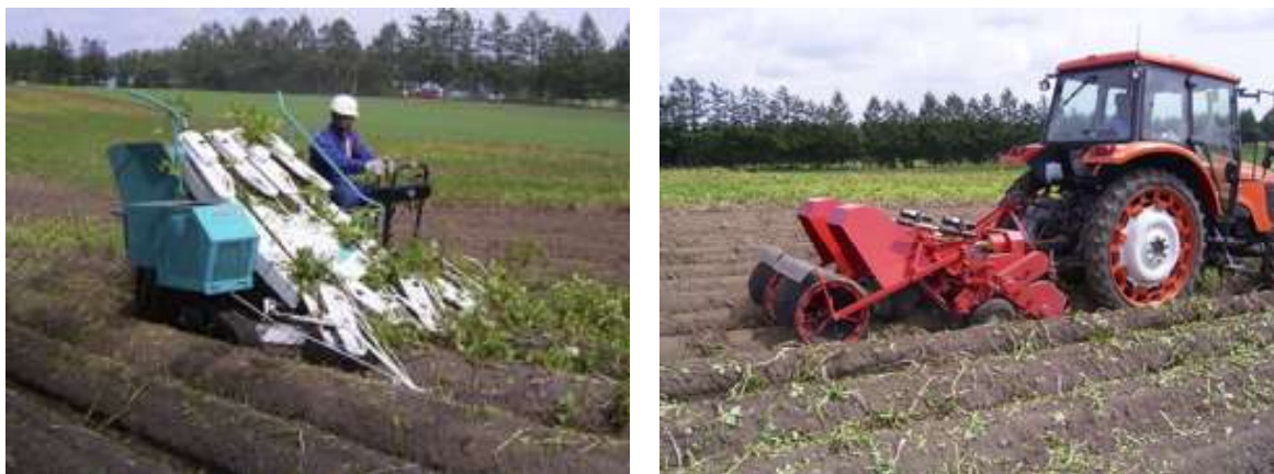
図2 いも類の収穫前茎葉処理機（左：自走式、右：トラクター装着式）
