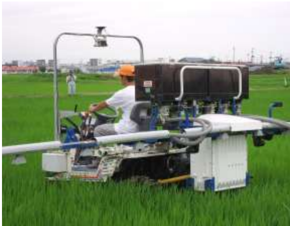
図2 追肥用可変施肥装置（左：粒状物散布装置、右：散粒機）
