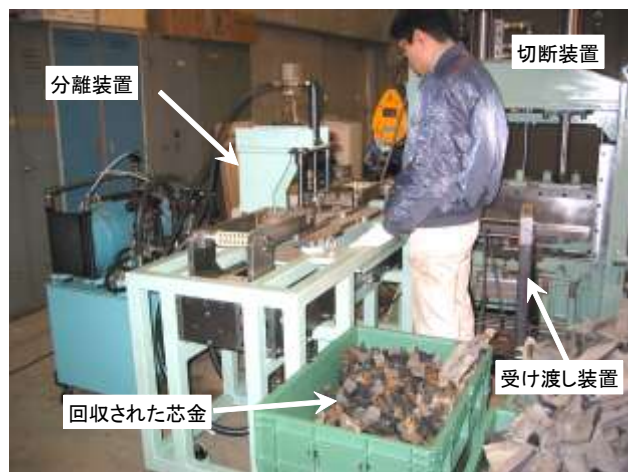
図 11 連続運転試験
