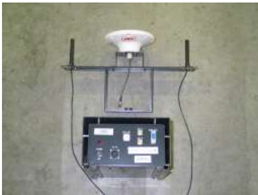
図 1 中精度 GPS 移動局 (基地局も構成は同一)
