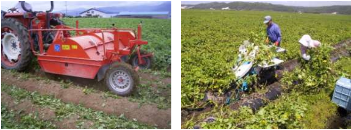
図1 現在利用されている茎葉処理機 (左：チョッパータイプ、右：1条処理のプラタイプ)
