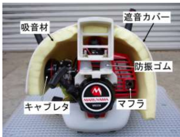
図8 低騒音2号機遮音カバーの外観
