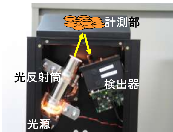
図4 反射式近赤外分光装置の測定部内部構造
