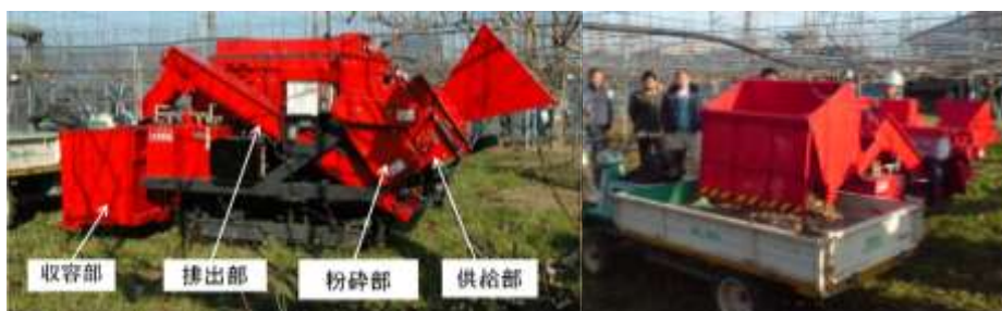
図20 自走投入式の外観及び荷下しの様子
