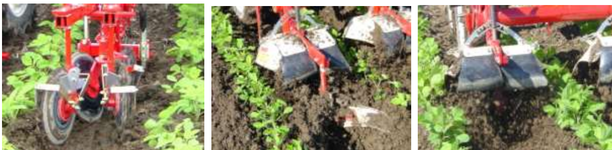
図5 湿潤な土壌における開発機(左)と従来機(中：R+m、右：R)の作業状況（2006年秋田）
