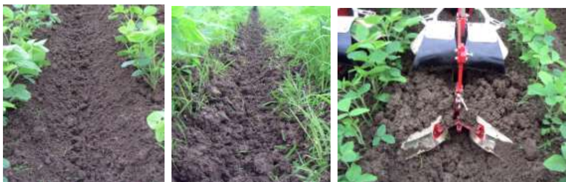
図7 開発機(左)と従来機(中・右：R+m)で砕土状態の差が大きかった例（2005年新潟転換畑）
