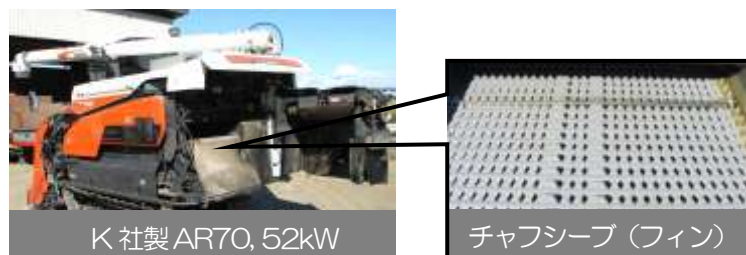
図14 はっ水加工を施した試作チャフシーブ
