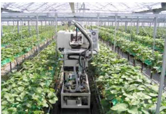
図5 高設栽培ベッドと開発機の外観
