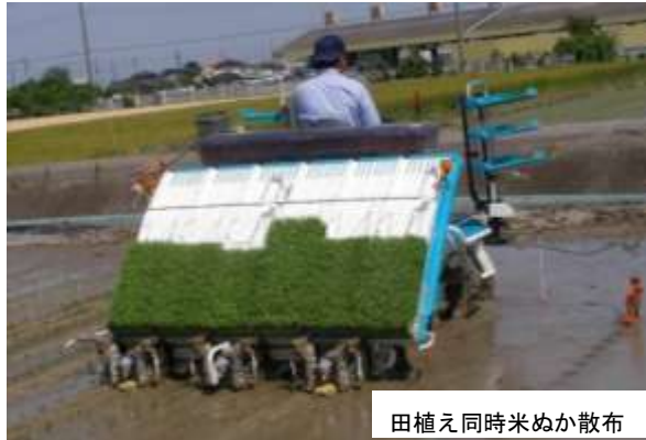
図1 多目的田植機と水田用除草機による田植え同時米ぬか散布と機械除草同時米ぬか散布
