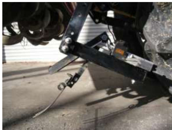
図 21 耕深センサ接地輪をレーキに変更
