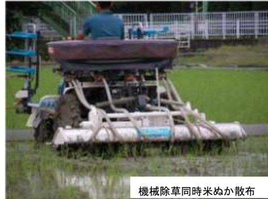
図1 多目的田植機と水田用除草機による田植え同時米ぬか散布と機械除草同時米ぬか散布
