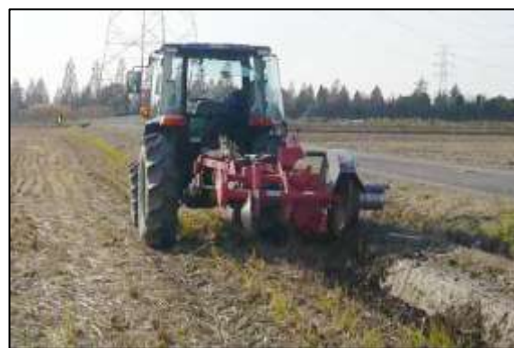
図12 作業風景 (排水口で作業機を上下操作)
