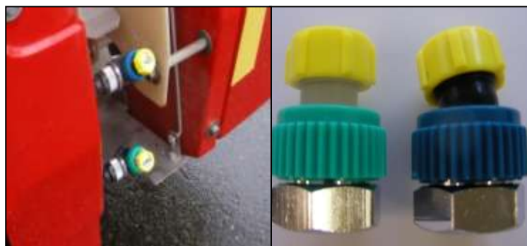
図 2 開発機のドリフト低減ノズル
