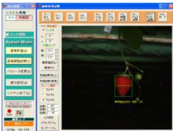
図6 ロボットの操作画面(果柄の検出)
