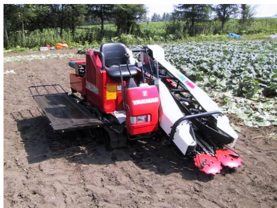
図1 従来のキャベツ収穫機 HC10 (緊プロ事業により2001年実用化)
