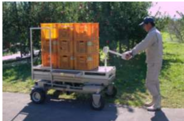
図4 開発機の運搬車としての利用
