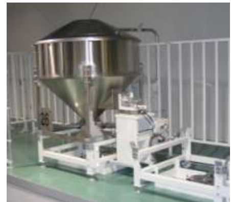
図6 籾殻混合貯留乾燥容器(1t)
