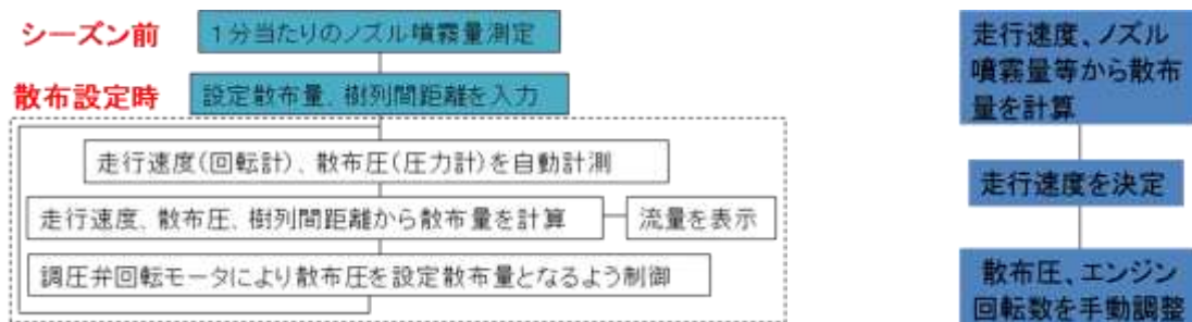
(a) 開発機の散布量設定と制御
