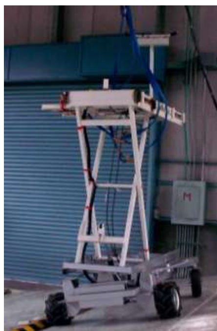
図 6 静的転倒角測定状況
