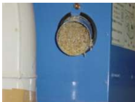
a) 脱ぶパイプの糠詰まり現象
