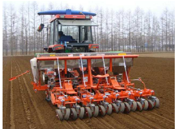
図1 耐風害播種床形成機構を装着した開発機
