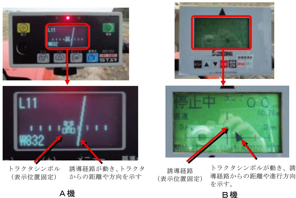
図7 経路誘導装置の画面表示例
