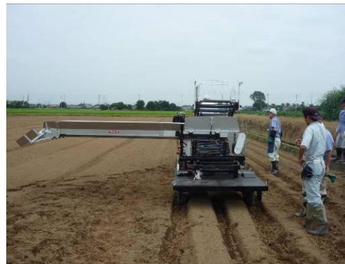
図9 横出しコンベア
