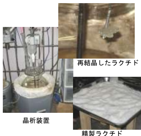
図4 精製ラクチドの作製
