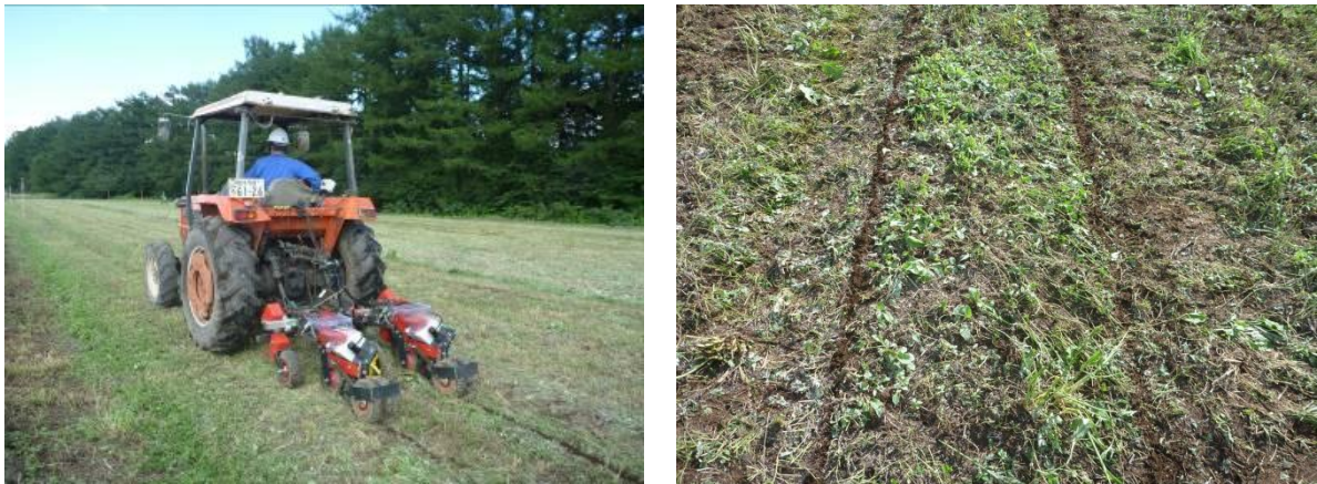
図6 不耕起ほ場での播種作業（左）と播種後のほ場表面（右）
