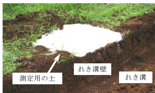
図 2 埋没測定用土の埋設状態
