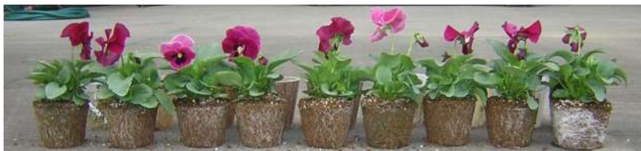
a: ポリ乳酸 100% b: 麦／ポリ乳酸ブレンド素材(麦 5%) c: 麦／ポリ乳酸ブレンド素材(麦 10%) d: 麦／ポリ乳酸ブレンド素材(麦 15%) e: 麦／ポリ乳酸コンポジット(麦 30%) f: ケミカルリサイクル再生ポリ乳酸 h: ケミカルリサイクル残渣樹脂 i: 慣行軟質ポリポット
