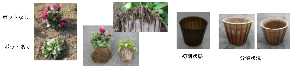
図8 花壇移植2ヶ月後のパンジーとポットの分解状態（麦 30%）
