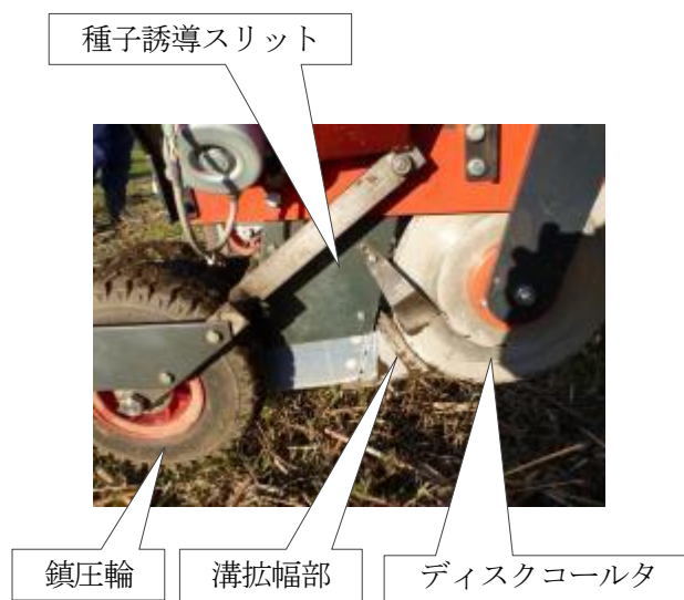
図5 高速種子土中定着機構
