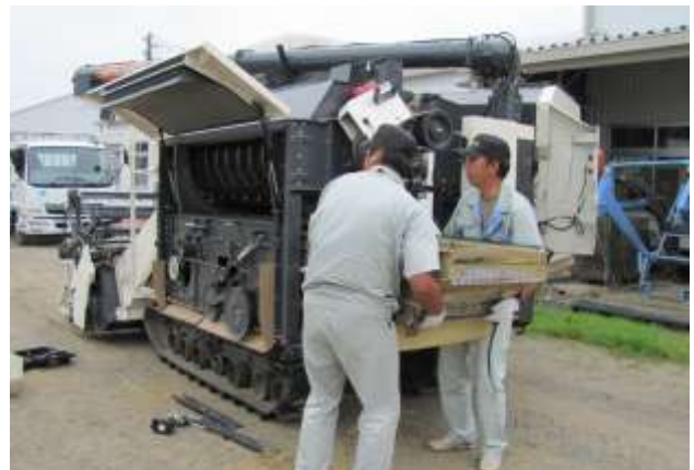
図4 スライド引き抜き式揺動選別部
