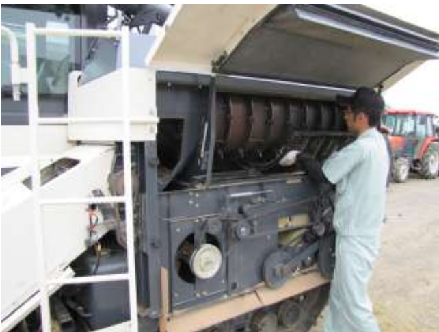
図3 跳ね上げ式サイドカバー
