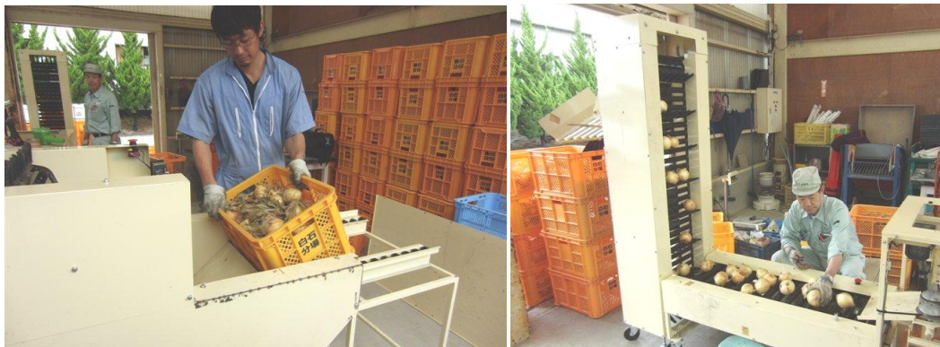
図4 2名1組での作業状況 (左: 供給部へのたまねぎ補給、右: 選別部での作業)
