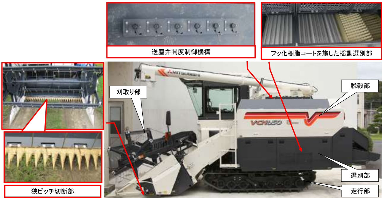
図5 小型汎用コンバインの構造
