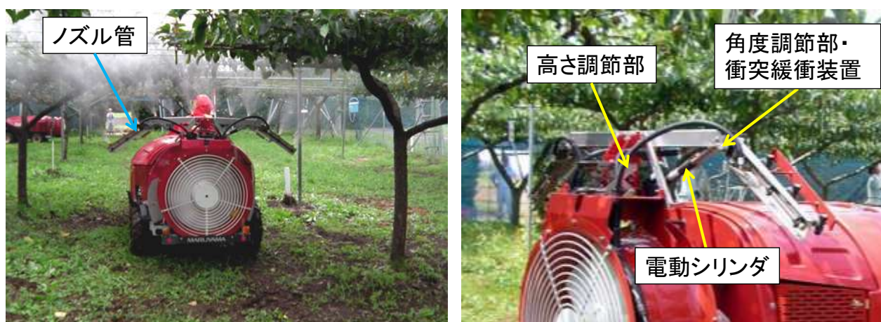
図 1 棚栽培用ドリフト低減型防除機
