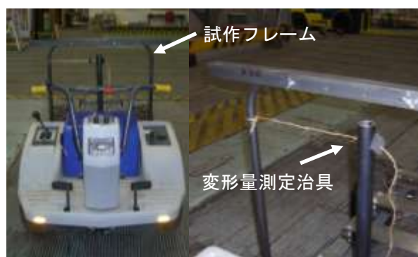
図 8 試作フレームを装着した農用運搬車と変形量測定ジグ
