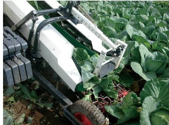
図6 キャベツの姿勢を制御するローラー
