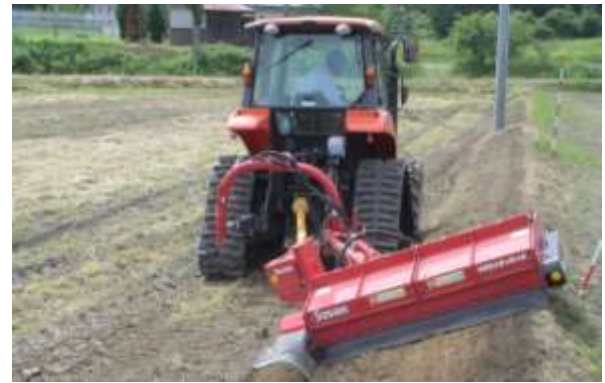
図4 法面表土の除染作業
