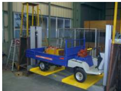
図4 重心高さ及び慣性モーメントの測定
