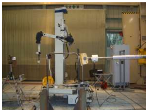
図 5 試作フレームの静的強度試験
