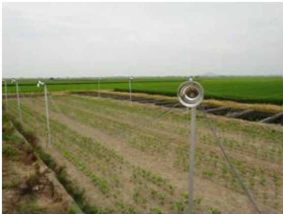
図5 エダマメ・ダイズ圃場における超音波防除試験（滋賀農技センター）
