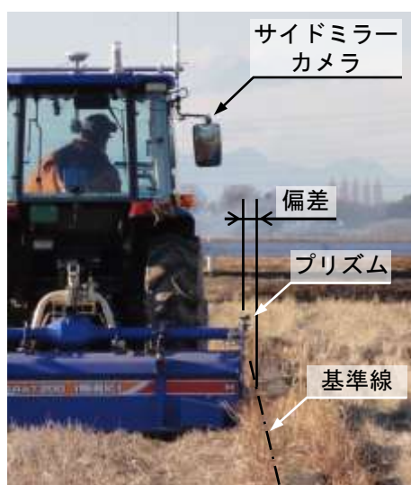
図6 畦畔併走試験風景と定義項目
