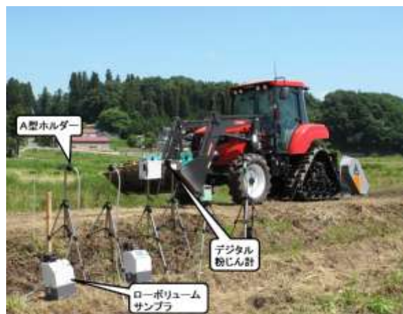
図11 除染作業時の粉じん測定
