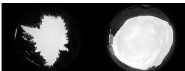
Fig.5 GPS観測点の天空率 左: 移動点(約30%), 右: 基準点(約70%), 画面下が北 The sky view of GPS points left: monitoring point(30%), right: datum point(70%)
