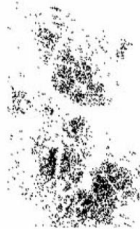
Fig.18 2回膨張処理のあと2回収縮処理した画像 (閾値=2300) The double erosion after double dilation image (threshold=2300)
