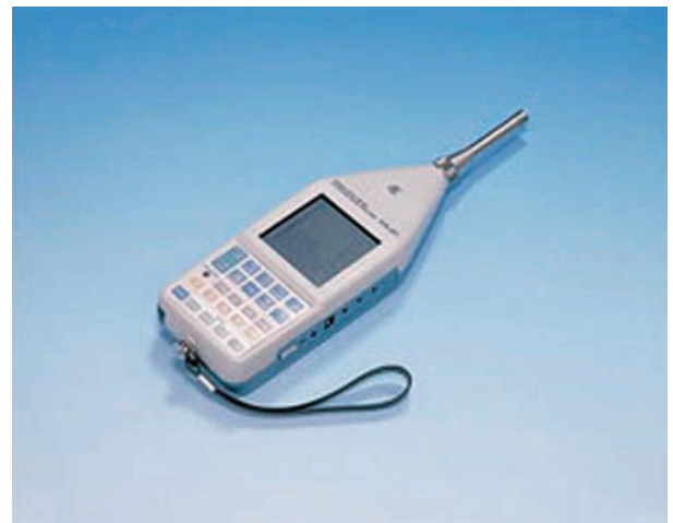
Fig.6 計測に使用した騒音計 Sound level meter
