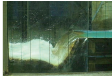
(a) 模型流量68l/s (現地流量 0.5\text{m}^3/\text{s} )
