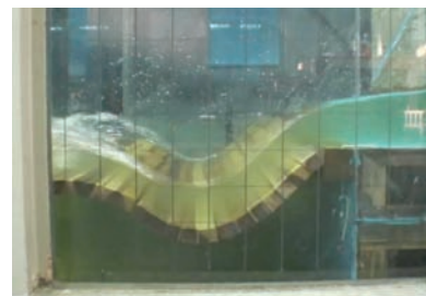
(d) 模型流量272l/s (現地流量 2.0\text{m}^3/\text{s} )
