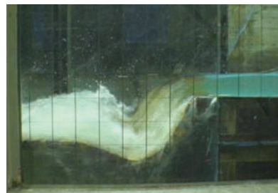
(b) 模型流量136l/s (現地流量 1.0\text{m}^3/\text{s} )
