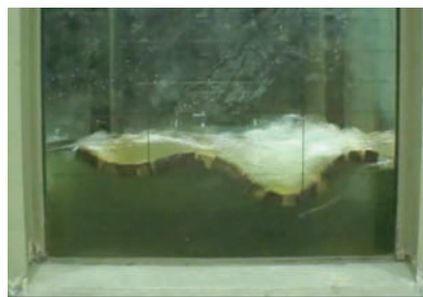
(d) 模型流量272l/s (現地流量 2.0\text{m}^3/\text{s} )
