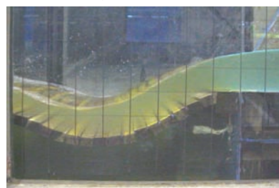
(e) 模型流量340l/s (現地流量 2.5\text{m}^3/\text{s} )
