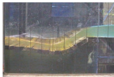
(c) 模型流量204l/s (現地流量 1.5\text{m}^3/\text{s} )
