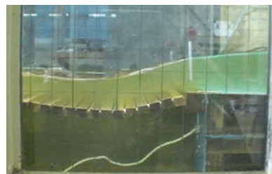
(e) 模型流量340l/s (現地流量 2.5\text{m}^3/\text{s} )
