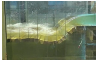
(c) 模型流量204l/s (現地流量 1.5\text{m}^3/\text{s} )
