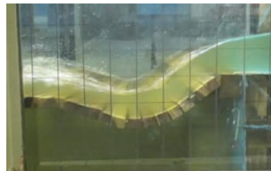
(d) 模型流量272l/s (現地流量 2.0\text{m}^3/\text{s} )
