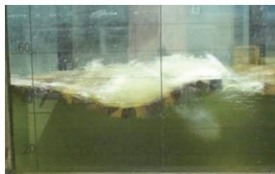
(d) 模型流量272l/s (現地流量 2.0\text{m}^3/\text{s} )
