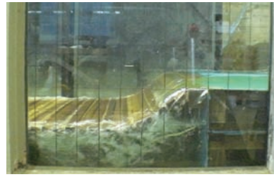
(a) 模型流量68l/s (現地流量 0.5\text{m}^3/\text{s} )
