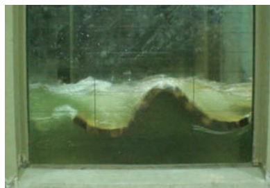
(e) 模型流量340l/s (現地流量 2.5\text{m}^3/\text{s} )
