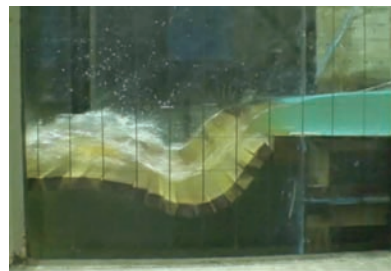
(c) 模型流量204l/s (現地流量 1.5\text{m}^3/\text{s} )
