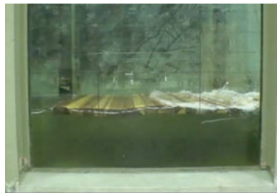
(c) 模型流量204l/s (現地流量 1.5\text{m}^3/\text{s} )
