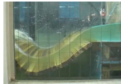
(e) 模型流量340l/s (現地流量 2.5\text{m}^3/\text{s} )
