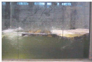
(c) 模型流量204l/s (現地流量 1.5\text{m}^3/\text{s} )
