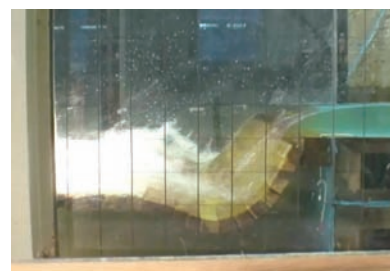
(b) 模型流量136l/s (現地流量 1.0\text{m}^3/\text{s} )
