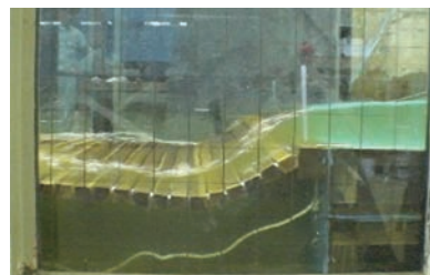
(c) 模型流量204l/s (現地流量 1.5\text{m}^3/\text{s} )
