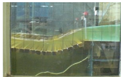
(d) 模型流量272l/s (現地流量 2.0\text{m}^3/\text{s} )
