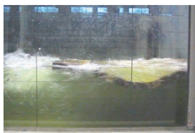
(d) 模型流量272l/s (現地流量 2.0\text{m}^3/\text{s} )
