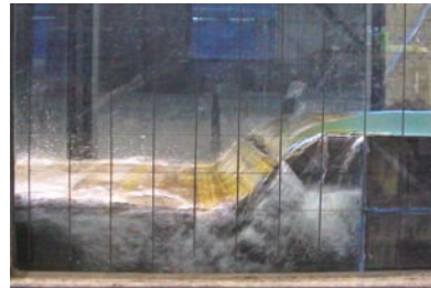
(a) 模型流量68l/s (現地流量 0.5\text{m}^3/\text{s} )
