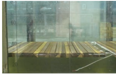
(a) 模型流量68l/s (現地流量 0.5\text{m}^3/\text{s} )
