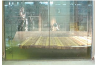
(a) 模型流量68l/s (現地流量 0.5\text{m}^3/\text{s} )
