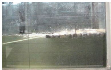
(d) 模型流量272l/s (現地流量 2.0\text{m}^3/\text{s} )
