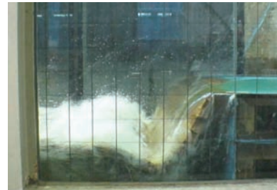
(a) 模型流量68l/s (現地流量 0.5\text{m}^3/\text{s} )
