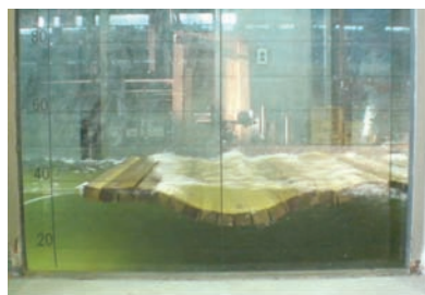
(b) 模型流量136l/s (現地流量 1.0\text{m}^3/\text{s} )
