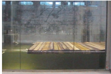
(a) 模型流量68l/s (現地流量 0.5\text{m}^3/\text{s} )
