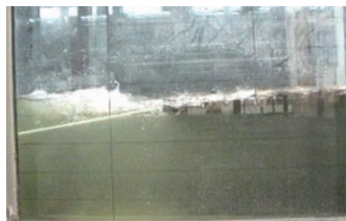
(e) 模型流量340l/s (現地流量 2.5\text{m}^3/\text{s} )
