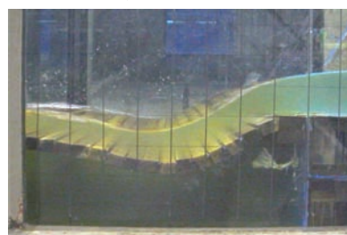
(d) 模型流量272l/s (現地流量 2.0\text{m}^3/\text{s} )
