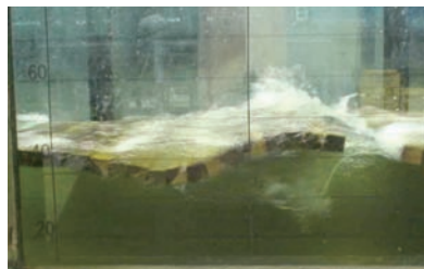
(c) 模型流量204l/s (現地流量 1.5\text{m}^3/\text{s} )
