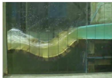
(d) 模型流量272l/s (現地流量 2.0\text{m}^3/\text{s} )
