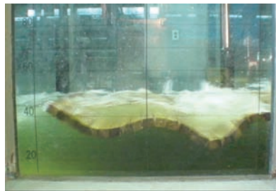
(c) 模型流量204l/s (現地流量 1.5\text{m}^3/\text{s} )
