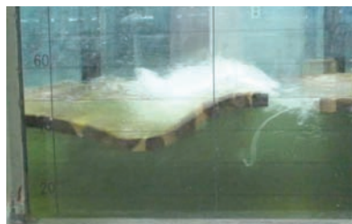
(e) 模型流量340l/s (現地流量 2.5\text{m}^3/\text{s} )
