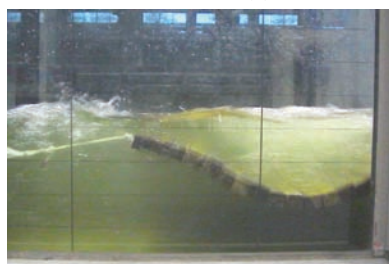
(e) 模型流量340l/s (現地流量 2.5\text{m}^3/\text{s} )
