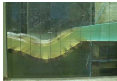
(e) 模型流量340l/s (現地流量 2.5\text{m}^3/\text{s} )
