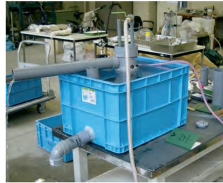
Fig.4 透水試験装置の外観
