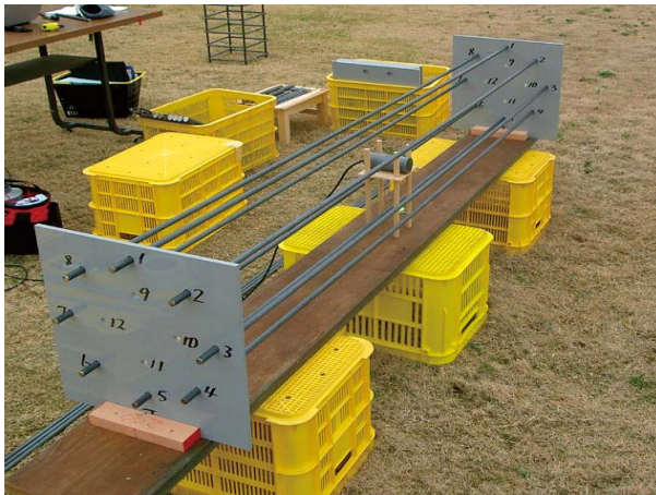
Fig. 17 主鉄筋影響試験 (φ13, 鉄筋長 200mm) View of effects test for reinforcing bar (diameter φ13, length = 200cm)
