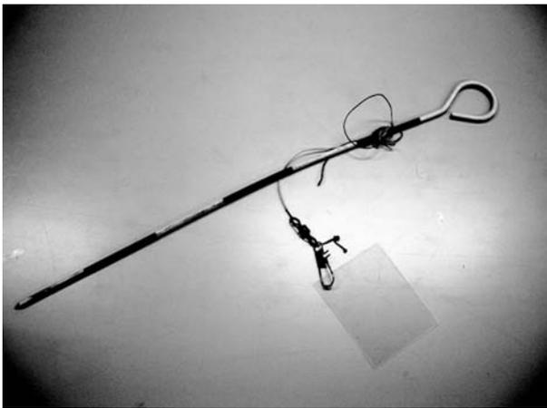
Fig. 3 湧水にフィルムを設置するための器具
