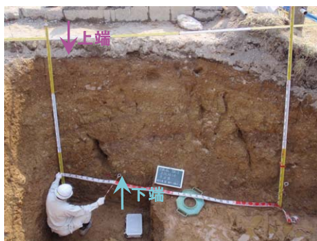
(a) 試掘トレンチ左岸壁面
