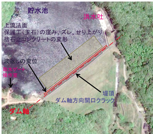
Fig. 45 西郷ダムの被災概要 (Google Earth 航空写真) Outline of damages of Nishigou dam
