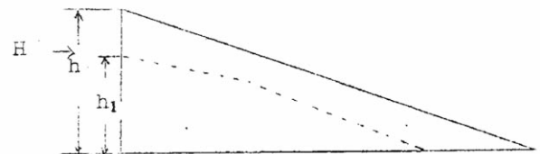
Fig. 10 羽鳥ダムの堤体の下流側の安定の評価 The stability evaluation at downstream body of Hatori dam
