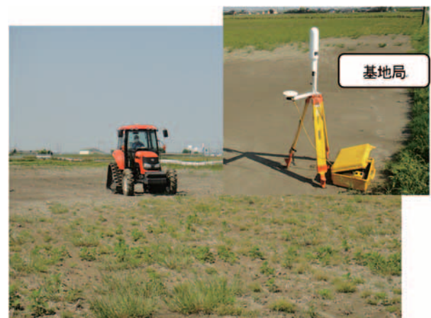
Fig. 7 RTK-GPS による測量 Survey by using RTK-GPS
