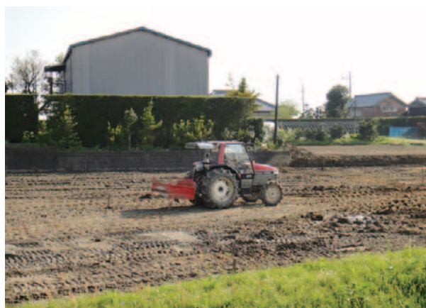
Fig. 16 トラクタダンプによる運土 Conveyance of soil by dumper tractor
