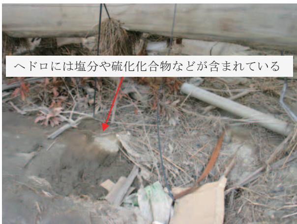
Fig. 25 温室に堆積したヘドロ Sludge accumulated on greenhouse floor
