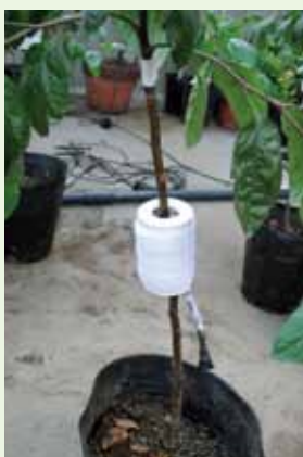
図1 サップフローメーターによる蒸散流量の測定
