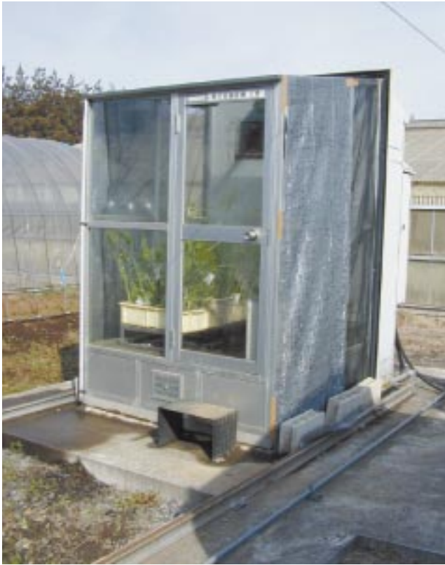
図4 加湿器を入れたグロスチャンバーにおける接種終了後の切り穂の養成（デジタル写真）
