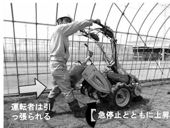
図 通常の作業状態(左)とダッシング後に急停止した時の再現(右)
