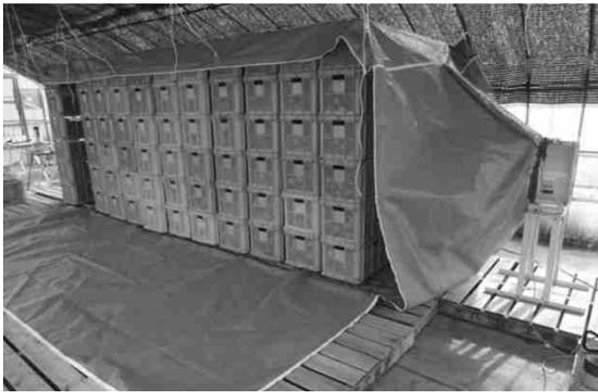
風洞内には高さ3cmの木材を長手方向に並べ、その上にコンテナを設置
