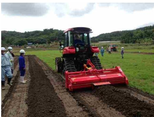
図2 表土削り取り試験状況
