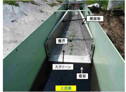
図3 用水路に設置した除塵装置
