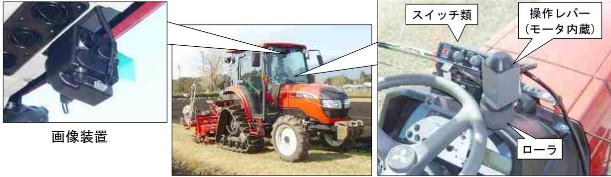
図1 直線作業アシスト装置の機器構成
