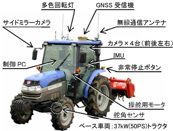
図1 ロボットトラクタ
