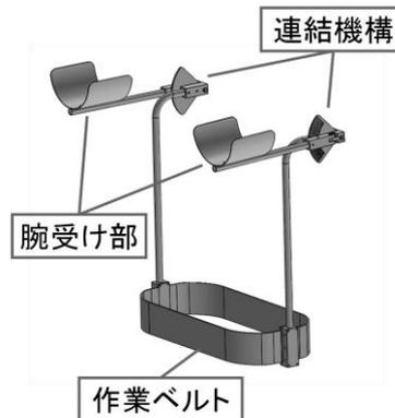
図3 腕上げ作業補助装置
