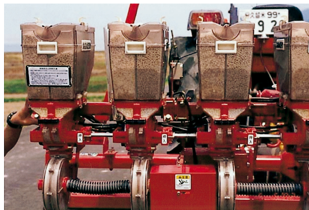
写真1 ホッパーを2分してLPコート入り複合肥料（右）と被覆粉（左）を充填した点播播種機
