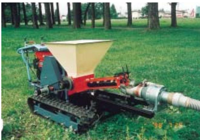
写真1 シードキューブ成形散布機
