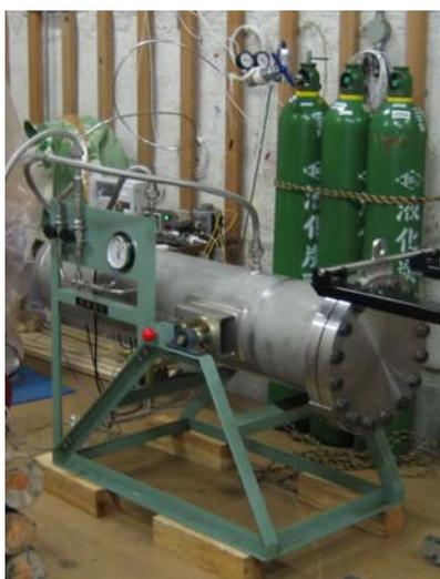
図 2 大型高圧炭酸ガス処理装置
